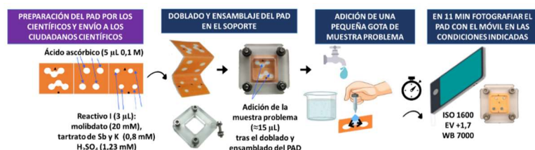
Figura 1. Esquema de procedimiento propuesto para llevar a cabo un proyecto de ciencia ciudadana para la determinación de fósforo como fosfatos en muestras de agua o extractos de suelo.
